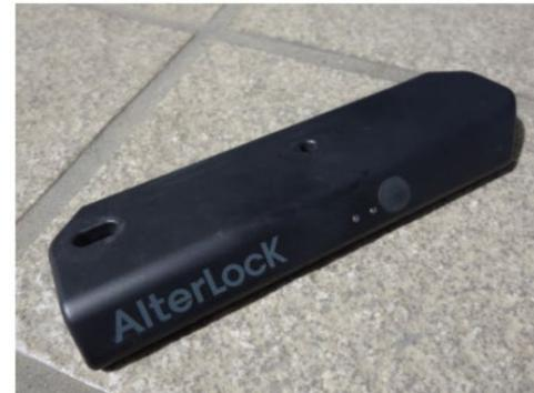
そこで近年は、IoT技術を活用し、鍵と併用することで盗難防止効果を狙った物が登場している。その中でも、注目されているのがAlterlockだ。Alterlockは振動検知アラーム+GPS+通信機能を搭載したスポーツ自転車向けの盗難防止サービス。Alterlockで振動を検知して、アラーム音を鳴らし、GPSで取得した位置情報を「Sigfox通信」でスマートフォンに送信する自転車盗難防止システムだ。
